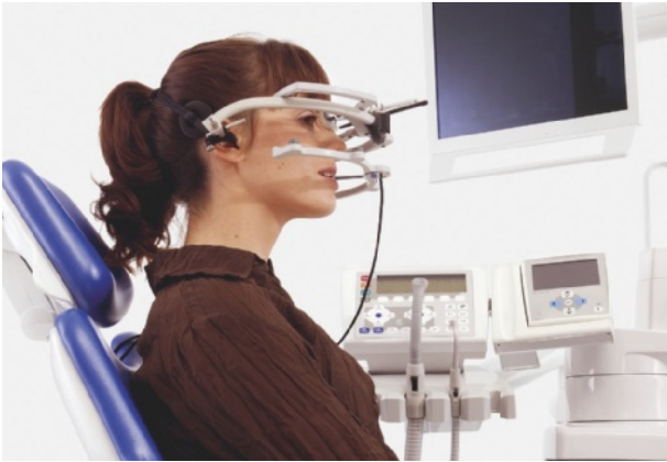
Abb. 1-2 ARCUSdigma 2 als Vertreter von Systemen zur berührungslos, auf Ultraschallbasis messenden Bewegungsaufzeichnung (Foto: KaVo).
