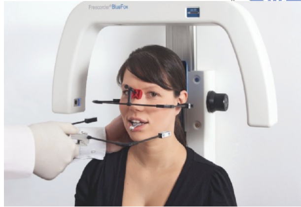
Abb. 1-3 Freecorder Bluefox als Vertreter von Systemen zur berührungslos, auf optoelektronischer Basis messenden Bewegungsaufzeichnung (Foto: DDI-Group).
